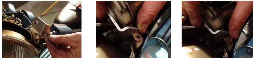
Neue Raste einbauen: Einstellschrauben in neue Raste schrauben, Bowdenzüge vor Montage der Raste einfädeln, Funktion prüfen. Spaltmaß zum Motorblock überprüfen, ggf. Motor nacharbeiten, dann Dichtung einlegen und Raste erst dann befestigen.
