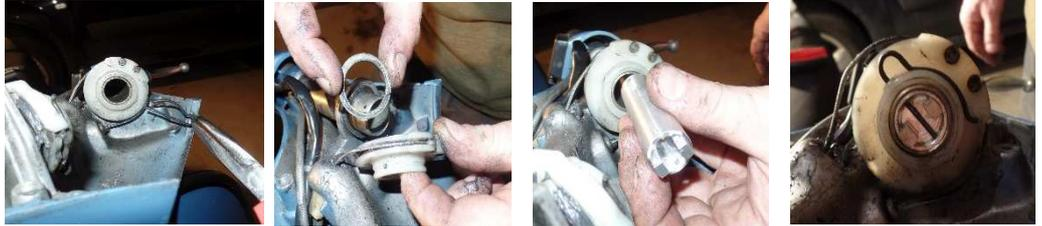
Scheinwerfer mit Momentenabstüzung spannungsfrei montieren.
