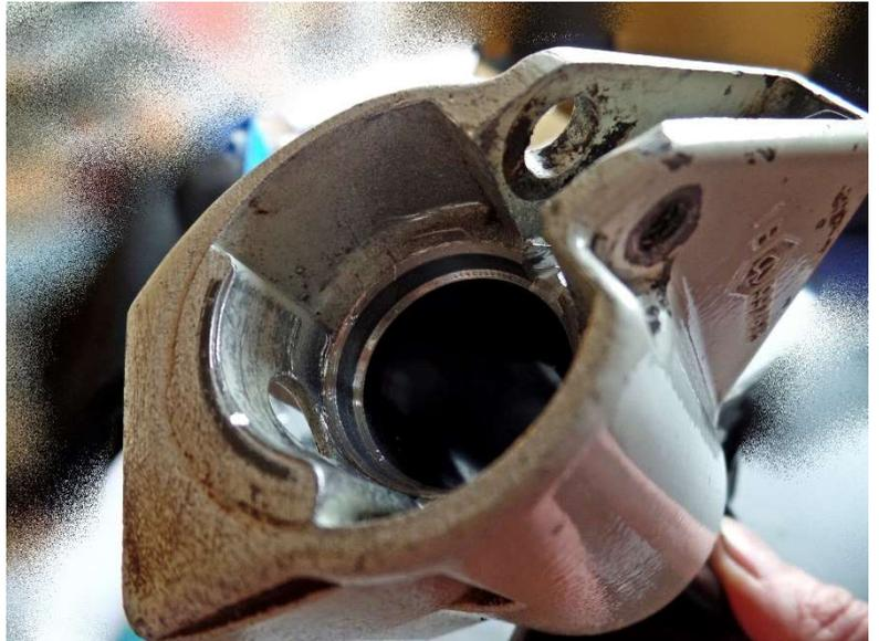
Dies geschieht am einfachsten mit einem Stufenbohrer auf einer Ständerbohrmaschine, alternativ mit einem Akkuschauber im eingebauten Zustand (nicht erprobt).
