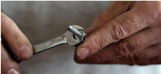
Hebel und Druckstange vorsichtig wieder ausbauen und mit der Mutter in der Länge fixieren.
