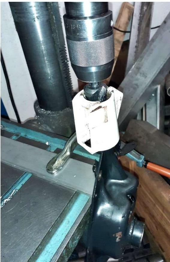
Nun mit dem Stufenbohrer das Stahlrohr kürzen, bis es bündig mit dem Alu ist.
