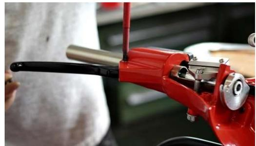
Bremsschlauch montieren und wie gewohnt Entlüften – viel Geduld und Schräglage sind von Vorteil.
