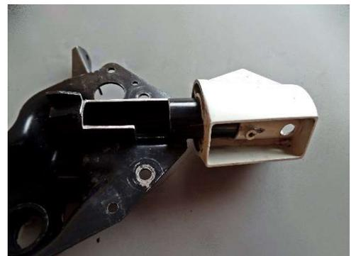
Unter dem Lichtschalter, knapp rechts neben der Befestigungsschraube ein Loch bohren und ein Gewinde **M4** schneiden, durch das Alugehäuse UND das Stahlrohr. Den mitgelieferten Gewindestift mit viel Schraubensicherung (zB Loctite) bündig eindrehen.
