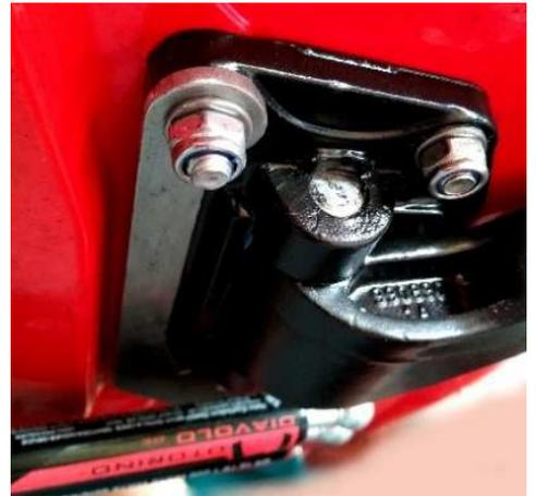
4. Die rechte Feder mit der dünneren Seite in Fahrtrichtung von links in die rechte Lasche vom Ständer einführen, mit je einer Unterlegscheibe rechts und links festschrauben. Anschließend die zweite Feder von links in die linke Lasche einfädeln und ebenso befestigen.
